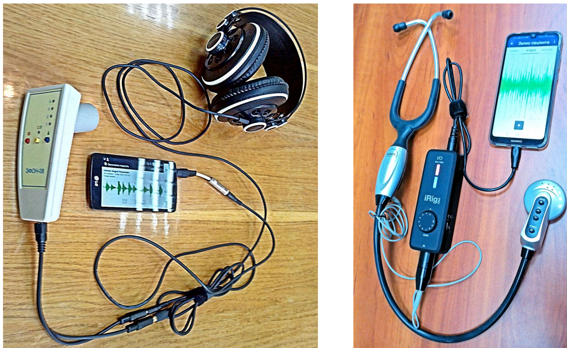
Рис. 4. Сучасні електронні стетоскопи при роботі зі смартфоном: а — ЕФОН-08 (використовуються зовнішні навушники); б — HEASCO JABES (спряжений через портативний мікрофонний інтерфейс)
