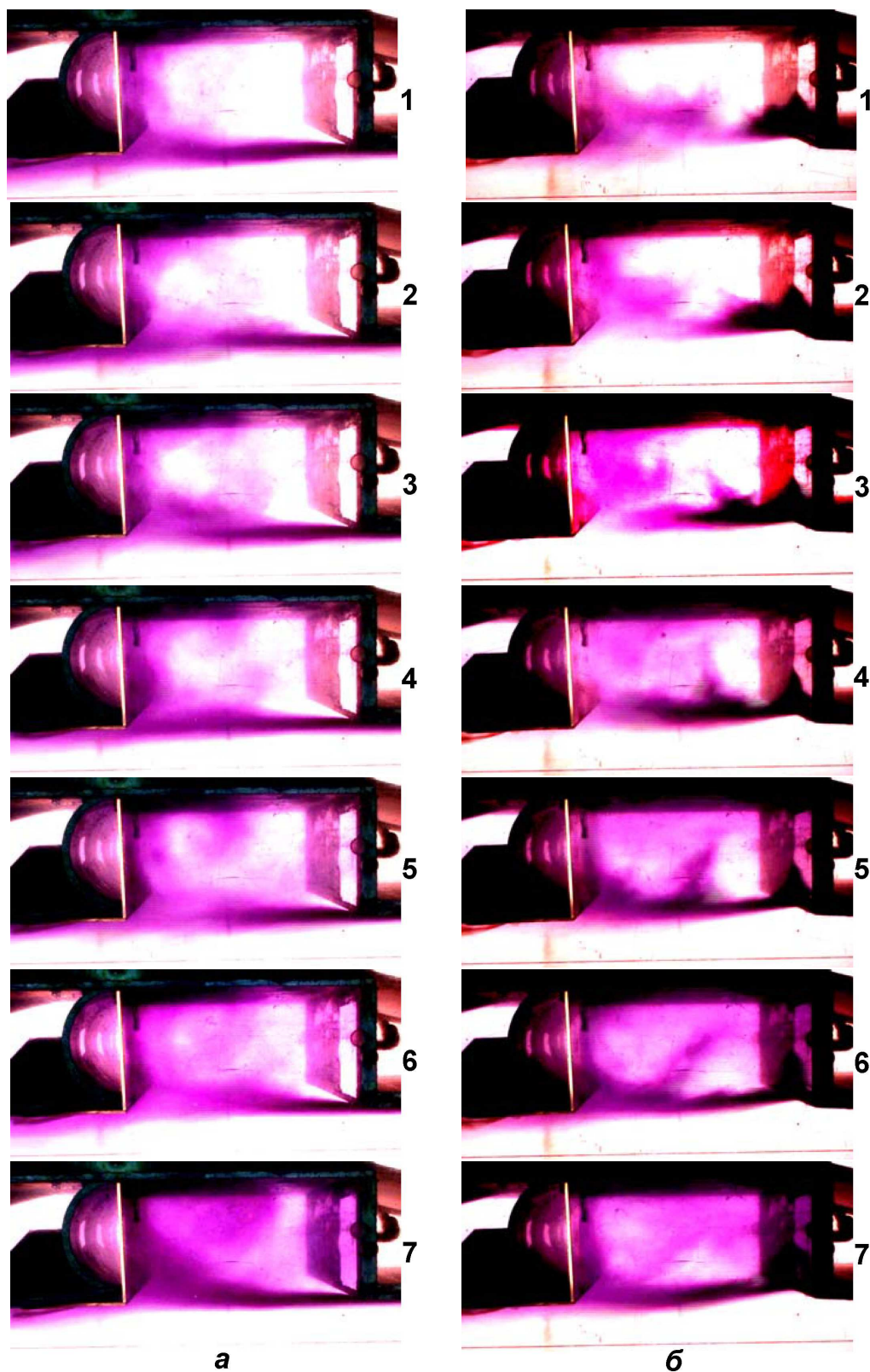
Рис. 6. Серия последовательных снимков с интервалом \Delta t = 0.04 с в камере при Re_l = 2.88 \cdot 10^5 ; l/h = 2.00 ; l/s = 0.400 . Колонка a – течение наружной струйки; б – внутренней
